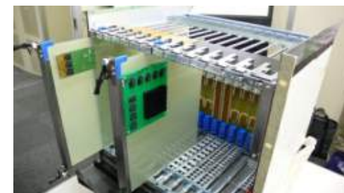
ATCAサーバモジュール全景
